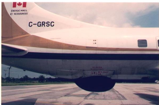
Figura 3 - Vista da antena na parte externa da aeronave com radome de proteção.
