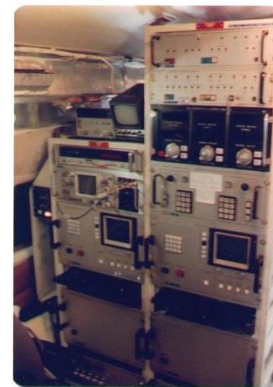
Figura 10 - Vista parcial da Estação de Controle do SAR (SAR Control Station) com o controle geral dos canais do SAR e da antena.
