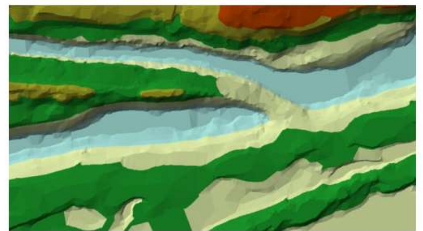
Ejemplo de Modelo Digital de Terreno en formato TIN, Curvas de Nivel correspondientes y sobre posición de las Curvas de Nivel sobre el Modelo.
