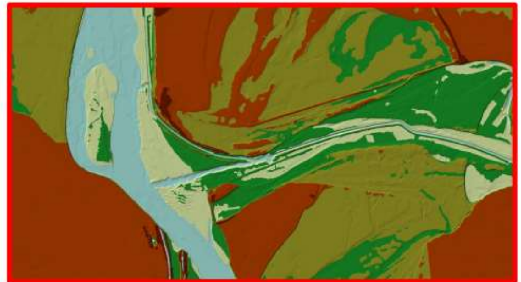
Modelo Digital de Terreno en formato TIN del área de la Embocadura.
