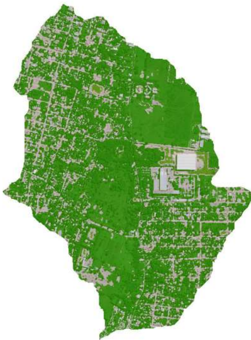
Imagen 2013 de la microcuenca clasificada para áreas permeables y impermeables
